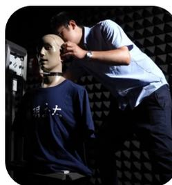
圖 2：「AI OTC」助聽器測試儀。
