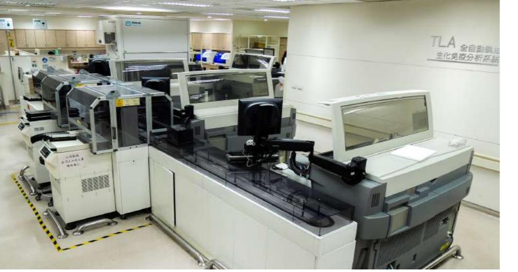
高速傳送系統，傳送至中正3樓之中央檢驗實驗室，透過檢體自動分類機，執行檢體分類與簽收，全程自動化之作業流程，取代傳統人工氣送、分類及簽收之作業流程，使門診急作血液檢體之傳送時間由25分鐘減少至4分鐘，在保證檢測品質之同時，更大大縮短醫生與病患之報告等候時間。
